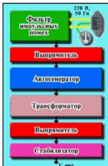
блок-схема источника питания Современный блок питания компьютера – сложное устройство, в котором стабилизированное напряжение вырабатывается после ряда преобразований
