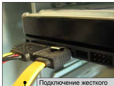
Подключение жесткого диска с SATA разъемом.
