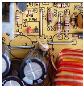
Фильтр импульсных помех. Нужный элемент в блоке питания, но к сожалению он часто отсутствует в дешевых блоках питания.
